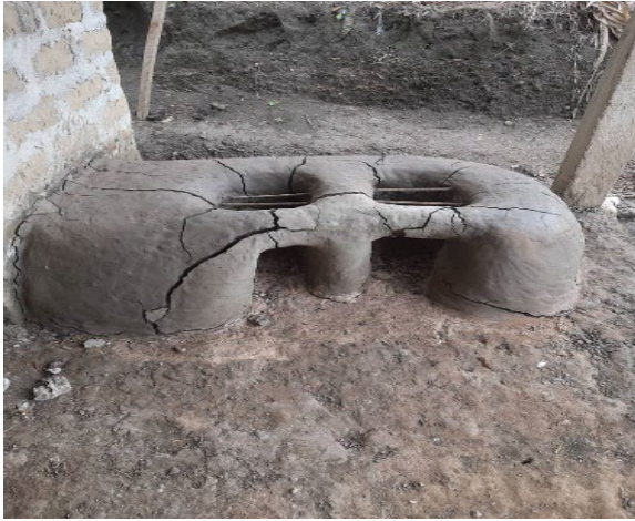
Construction de foyer amélioré à Laminata
